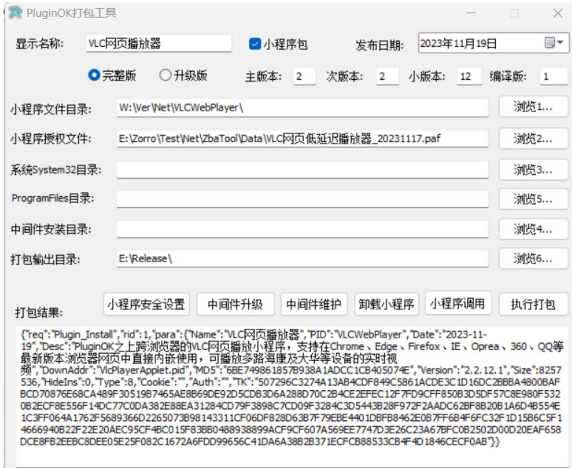
勾选小程序包开关时，可选择打小程序的完整包还是打升级包，必须设置小程序文件目录、小程序授权文件、打包输出目录，并确保小程序文件目录已经放入其配置文件。如果你的小程序有些支持库或其他配置文件需要放到操作系统的 System32 目录下，请设置系统 System32 目录并放置对应的文件，同理如有支持库需要放置到 PluginOK 程序主目录时，请设置中间件安装目录并放入对应的程序文件，如果没有就不用设置，ProgramFiles 目录同理，切不可直接设置操作系统的相关目录直接进行打包。上述设置的几个磁盘目录，请确保不要是相互嵌套的目录结构，也无其它无关的文件，以避免打包后的文件过大。存放小程序的目录等都支持子目录结构，子目录下的文件也都会自动打包进入最终的程序包中。需要注意的是，虽然 PluginOK 授权支持自定义显示产品名称，但其执行程序、运行库 DLL 及配置文件的名称等是不能修改的，否则会导致整个系统运行异常。
