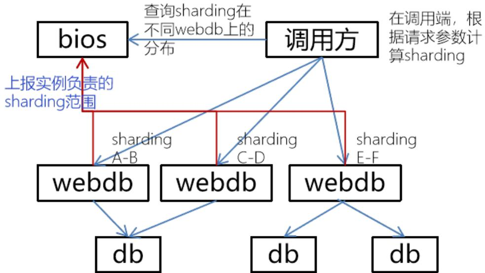
每个 webdb 实例负责一个分片范围，在它启动后会定期向 bios 服务上报自己的分片范围，调用方发起请求时需要先从 bios 中获得分片分布情况，然后再根据接口定义中 sharding 计算结果，找到合适的 webdb 实例。
