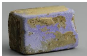
图 2 风化的玻璃棋子样品
