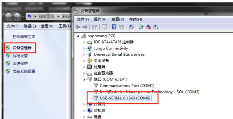
我这里显示的是 COM6，所以要在 sscom 工具中选择 COM6，开发板程序波特率设置为 115200，所以我在 sscom 串口工具中选择 115200 波特率。
