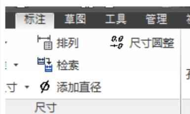
**添加直径:** 在工程图选择一个尺寸, 在尺寸前添加Φ。
