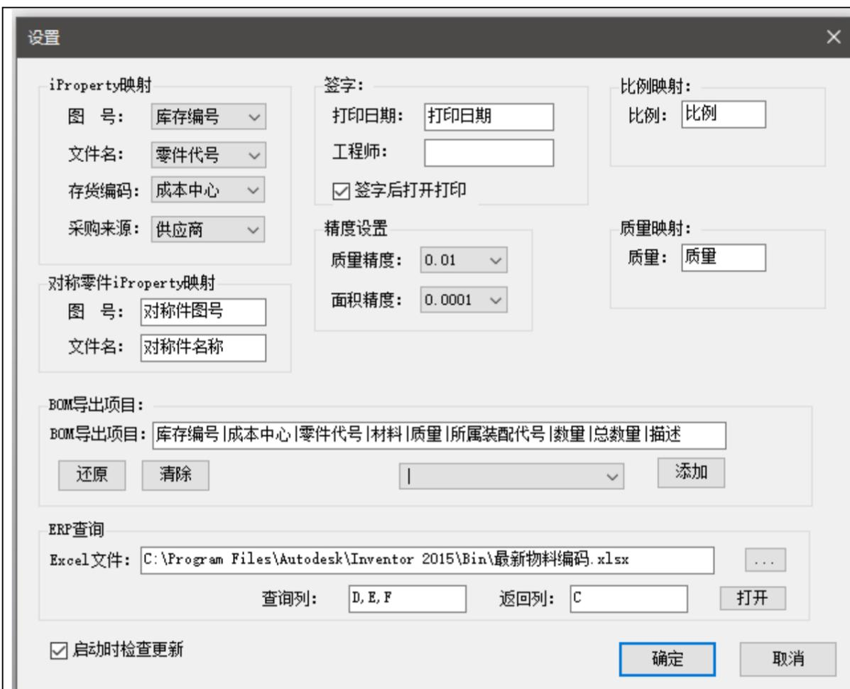
**设置:** 设置【工程师】【打印日期】【零件代号】【库存编号】【对称件代号】【对称件名称】【对称件编码】【质量】【比例】等 iProperty 数据映射。
