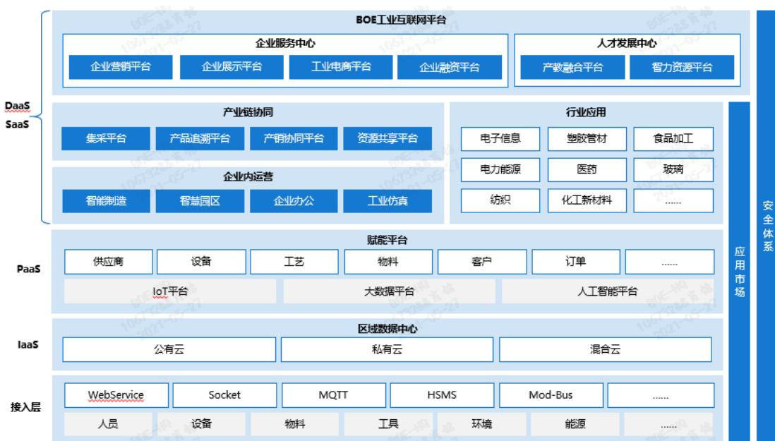
接入层：提供海量工业数据接入、转换、数据预处理和边缘分析应用等功能。一是工业数据接入，包括机器人、机床、高炉等工业设备数据接入能力，以及 ERP、MES、WMS 等信息系统数据接入能力，实现对各类工业数据的大范围、深层次采集和连接。二是协议解析与数据预处理，将采集连接
